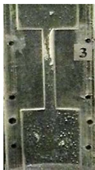
Рис.8. Фотографія прозорого каналу з рідиною, що коливається в момент втягування рідини у камеру пульсації: виникнення кавітаційної каверни та кавітаційних пухирців при частоті коливань 5 Гц
