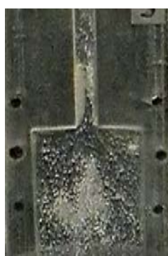
Рис.12. Фотографія прозорого каналу з рідиною в момент початку виштовхування рідини з камери пульсації: виникнення кавітаційної каверни та кавітаційних пухирців, що ще не сплеснулися при частоті коливань 10 Гц
