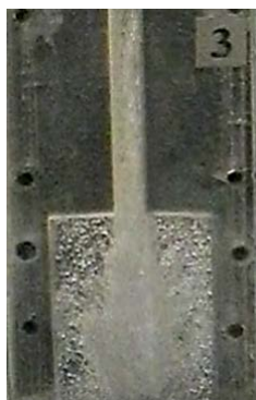
Рис.10. Фотографія прозорого каналу з рідиною в момент втягування рідини у камеру пульсації: виникнення кавітаційної каверни та кавітаційних пухирців при збільшенні частоти коливань до 14Гц
