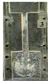
Рис.9. Фотографія прозорого каналу з рідиною, що коливається в момент втягування рідини у камеру пульсації: виникнення кавітаційної каверни та кавітаційних пухирців при збільшенні частоти коливань до 10 Гц
