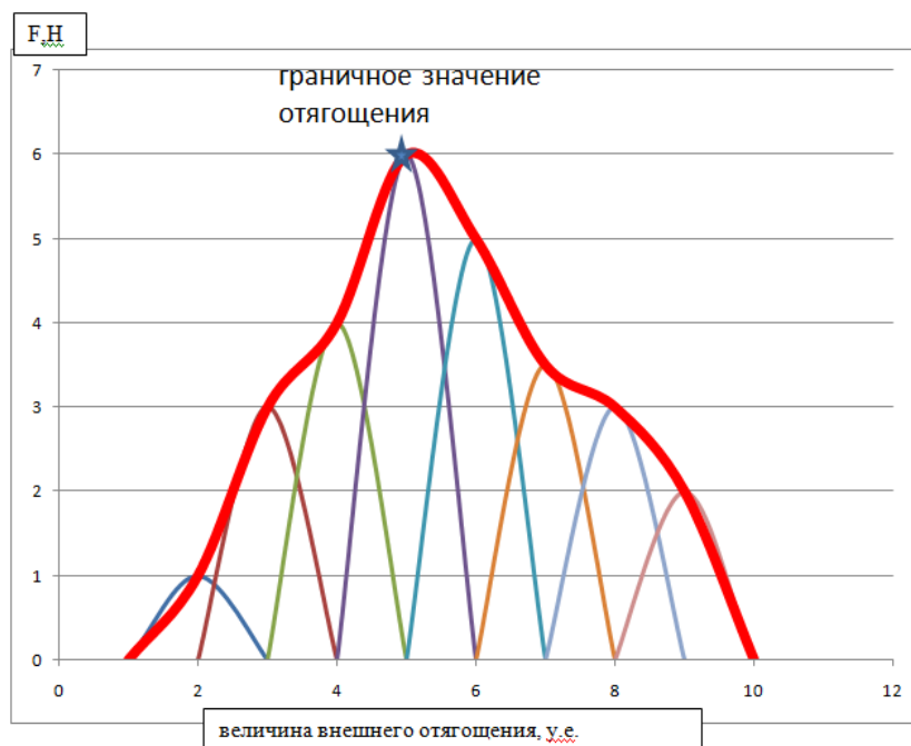
Рис. 3. Определение граничного значения отягощения при ступенчатом повышении нагрузки в тяге на нижнем блоке. * – граничное значение отягощения, тонкие кривые – усилие при каждом отягощении, утолщенная кривая – кривая, определяющая максимальные значения усилия при каждом отягощении
