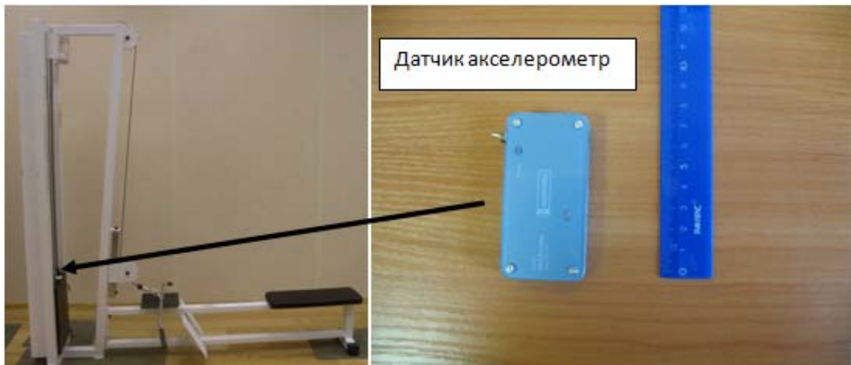
Рис. 2. Датчик-акселерометр и место его крепления в подвижной части тренажера
