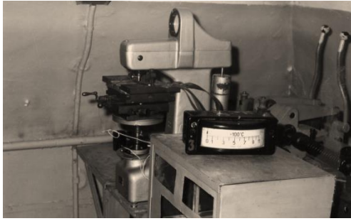
Рис. 2. Установка для змінення твердості при підвищених температурах: а – загальний вид установки, б – вузол нагріву
