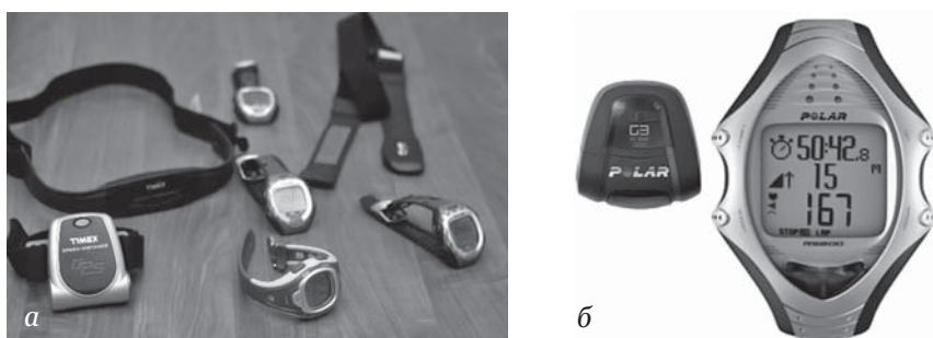
Рисунок 2.3 — Пульсометри, які використовують у спортивній практиці: а — види пульсометрів; б — складові пульсометра: датчик та годинник
