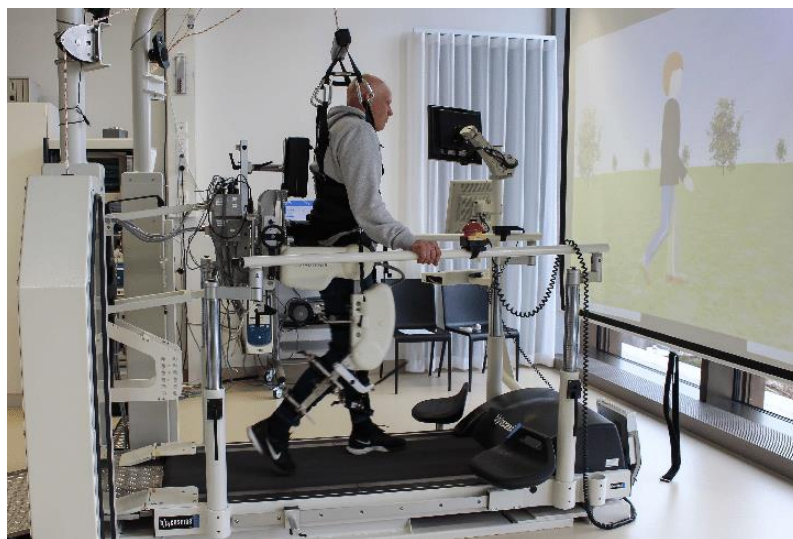
Рисунок 1.8 – Lokomat (Hocoma AG, Швейцарія) — двосторонній роботизований ортез для ходи.
