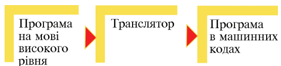
Рисунок 1.3. – Схематичне представлення роботи транслятора
