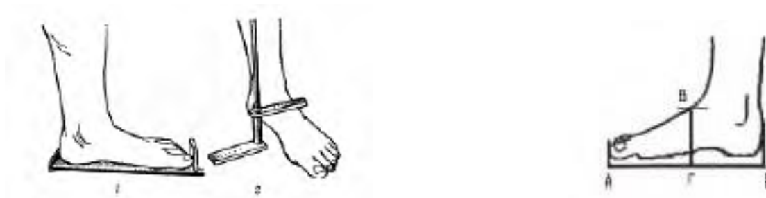
Рисунок 2.2 – Подометричний метод вимірювання форми стопи за Фрідляндом
