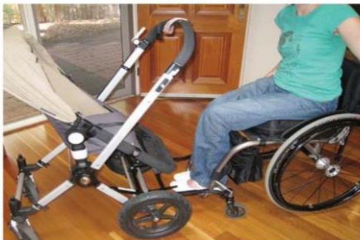
Мал.14[21] – Спеціальне з'єднання, для уникнення необхідності тримати дитячу коляску під час управління кріслом колісним.
