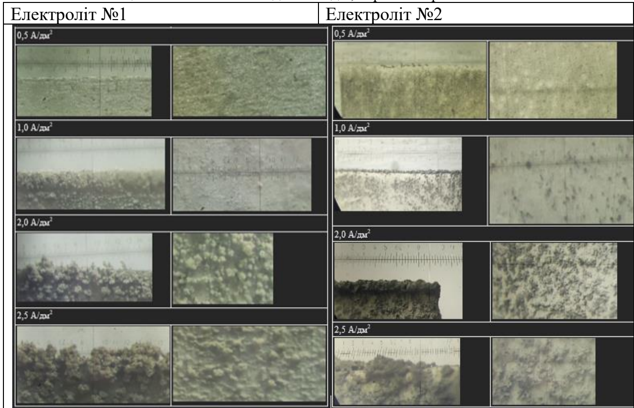
Таблиця 3. Фотознімки катодних осадів, отримані при збільшенні x50
