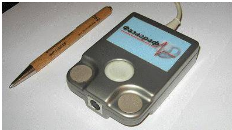
Рис. 2.1. Мікропроцесорний сенсор приладу Фазаграф
