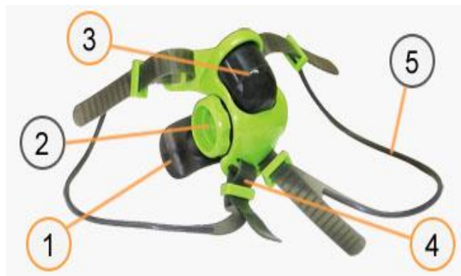
Рис. 2а. Тренажер комплексного воздействия на дыхательную систему спортсменов: 1 – корпус тренажера с загубником, 2 – нагрузочное устройство с клапаном выдоха, 3 – клапан вдоха, 4 - держатель, 5 – ремни
