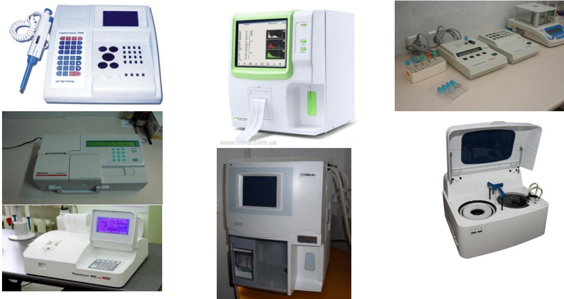
Рис 4.11.6 Біохімічна апаратура для контролю показників крові спортсменів: а — коагулометр напівавтоматичний «TS 4000», мобільний аналізатор газів крові та електролітів «Ортисса», біохімічний аналізатор Humalyzer 3000LP-400, б — автоматичний гематологічний аналізатор MicroCC 20 plus та гематологічний аналізатор Erma PCE-210, в — мобільний біохімічний аналізатор-фотометр LP-420 «Dr-Lange» та аналізатор біохімічний «Diaglobal Vario Photometer II»
