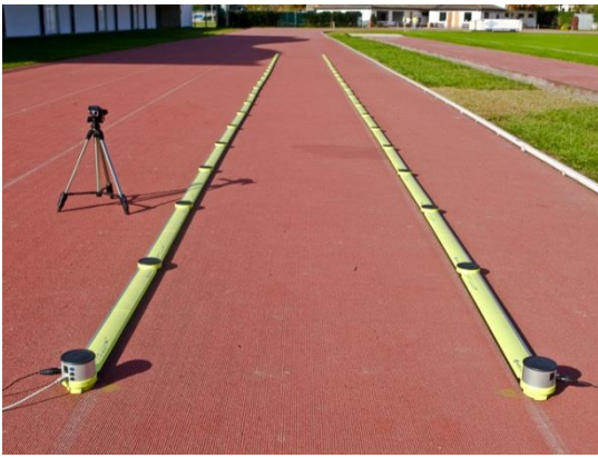
Рис. 4.11.15 Фрагмент реєстрації кінематичних характеристик різних локомоцій з використанням оптичної системи «Ортоjump»
