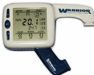
Рисунок 4.21 — Приклади вимірювання шкірних складок каліпером (а) та різновиди каліперів (б)
