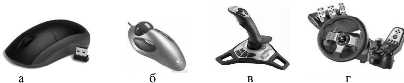
Рисунок 1.18 – Маніпулятори: а – миша; б – трекбол; в – джойстик; г – комп'ютерний руль
