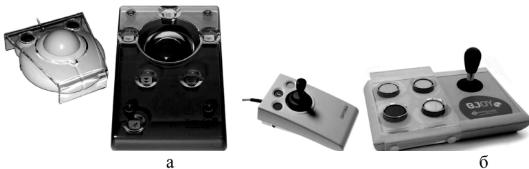
Рисунок 1.19 – Маніпулятори спеціальної конструкції: а – трекболи; б – джойстики
