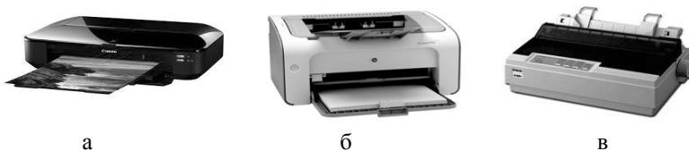
Рисунок 1.23 – Типи принтерів: а – струменевий; б – лазерний; в – матричний
