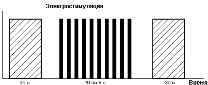
Рис. 1. Тренирующий блок ЭМС, направленный на развитие силы мышц
